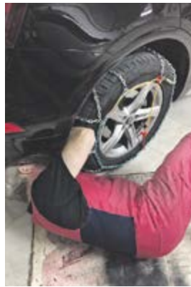
Timo Tamps pyörytti lumiketjun renkaan päälle muutamassa minuutissa. Amatööriltä kuluu aikaa varmasti enemmän. Ketjujen istuvuus ja riittävä kireys on tärkeää. Etupuolella on lenkkejä, joista ketjun saa kiristettyä.
